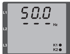
Fig.: No puede detectarse ningún sentido del campo giratorio.
